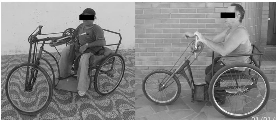
Figura 1 - Handcycle artesanal manufaturada pelo próprio usuário
