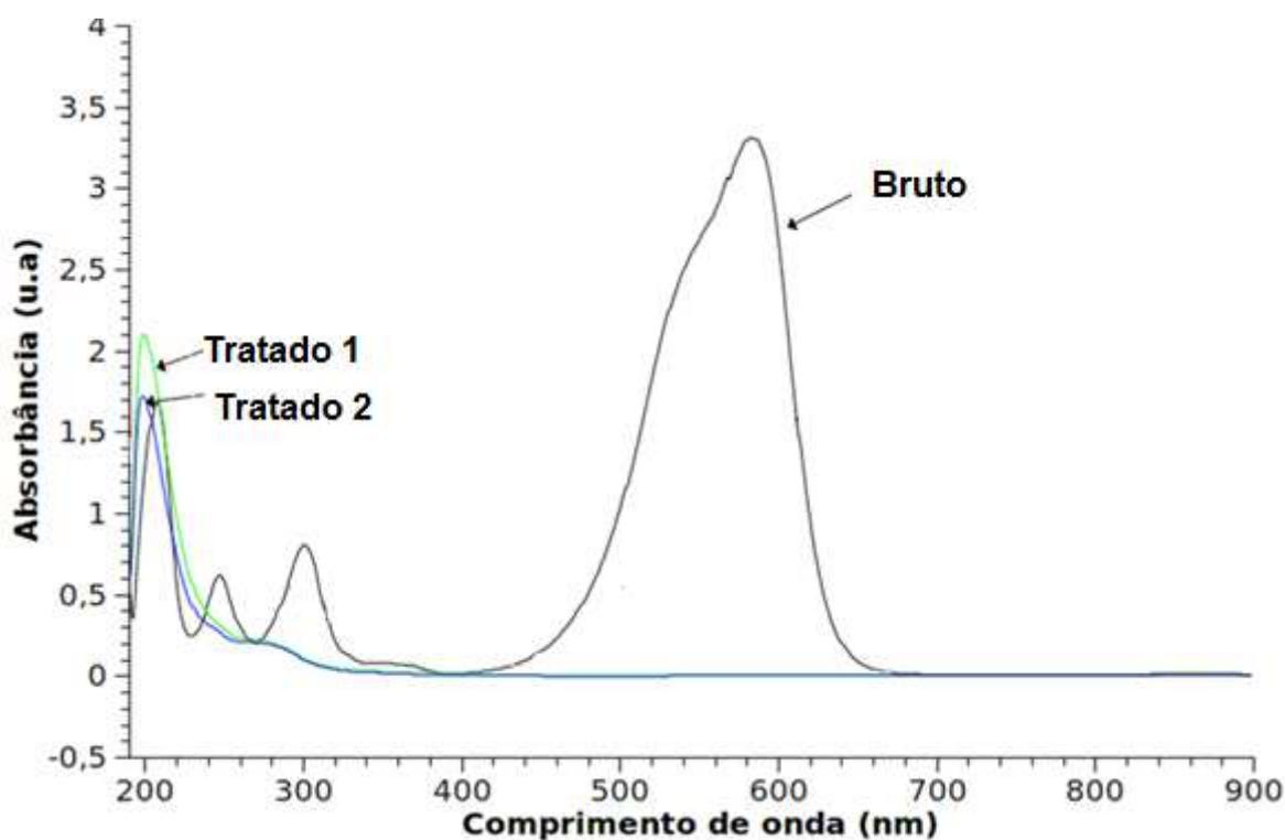
**Figura 5** – Varredura espectrofotométrica dos efluentes bruto e tratado referente ao experimento com uma célula de tratamento.
