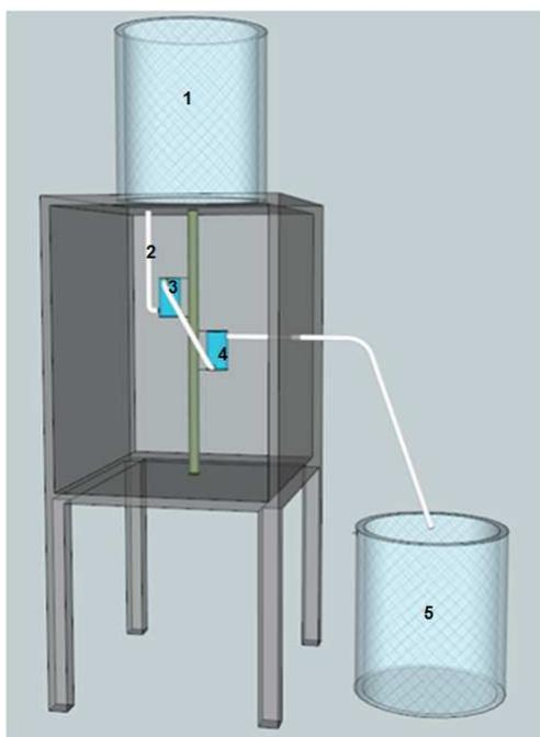
**Figura 2** – Esquema do reator no experimento com duas células em série: (1) Bombona de armazenamento de efluente, (2) tubulação, (3) célula 1, (4) célula 2, (5) bombona de captação final do efluente tratado.
