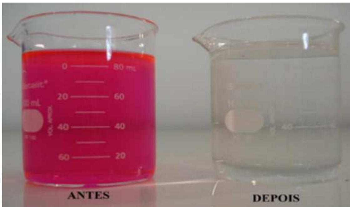
**Figura 7** – Aspecto visual do efluente sintético antes e após o tratamento de fotodegradação.
