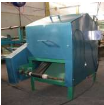
Figura 3 – Equipamento separador do PVC e poliéster
