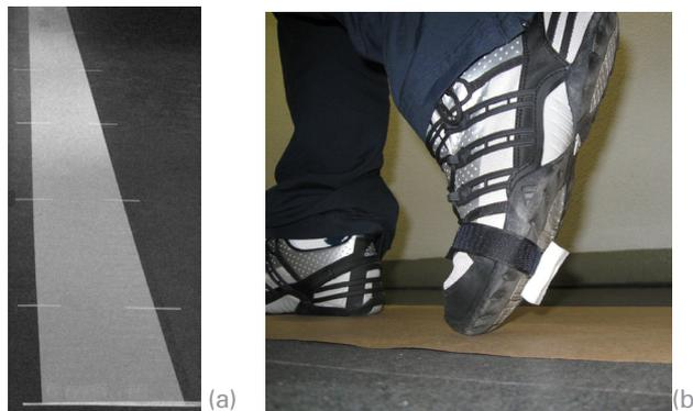
Figura 1 - (a) Vista superior do papel colado no solo com 60 metros de comprimento e 0,60 metros de largura e (b) cinta com velcro fixada na parte anterior de ambos os pés.
