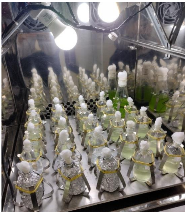
Figura 2. Cultivos em fotobiorreatores em incubadora tipo shaker.
