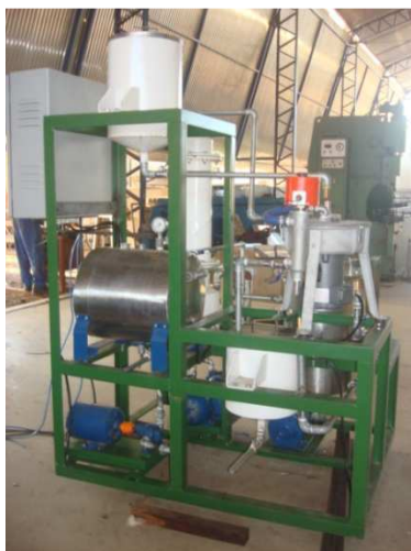
Figura 4 – Unidade de secagem e centrifugação do óleo de mamona.
