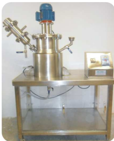
Figura 2 – Unidade de degomagem do óleo de mamona com controle de agitação e aquecimento.
