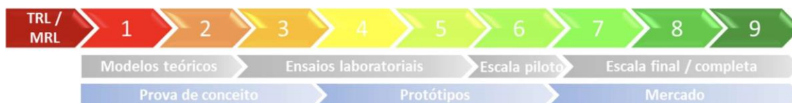
Figura 2 - TRL - Technology ReadinessLevel para as soluções já encontradas
