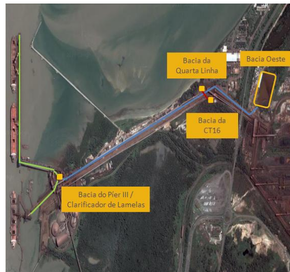
Figura 9- Sistema de drenagem do embarque [38]
