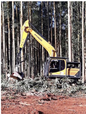
Figura 2 – Máquina base equipada com cabeçote processador utilizados para o abate das árvores.
