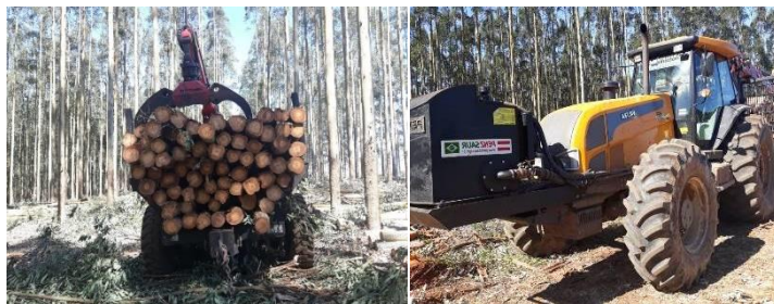
Figura 3 – Trator e reboque autocarregável utilizado no baldeio da madeira, com \frac{3}{4} da capacidade.
