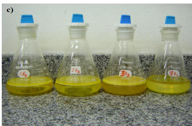
Figura 2 – Passadas 24 horas da preparação. Comparação entre a separação de fases das emulsões óleo água analisadas, contendo os surfactantes: 1A Tween20; 2A Tween80; 3A Lauril Éter Sulfato de Sódio e 4A Cetiol HE, após 24 h (a), 168 h (b) e 360 h (c) de repouso.
