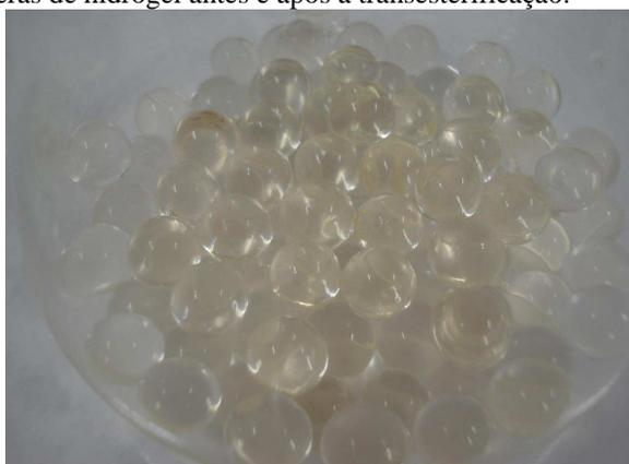
Figura 1 – Esferas de hidrogel com enzima imobilizada.
