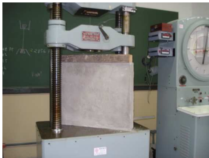
Figura 3 – Teste de resistência a compressão após 28 dias de cura, da placa de dimensão de 60x60x10cm
